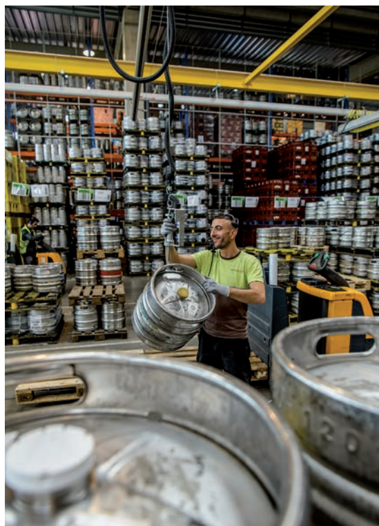
Préparation de commandes aidée par un portique à fûts.
