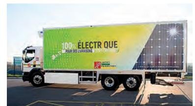
à partir des batteries de traction 600 V du véhicule (et non à partir d'un générateur annexe). Le camion est également équipé de panneaux photovoltaïques situés sur le toit, afin notamment d'alimenter le hayon élévateur. ■
